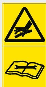
Forsøg ALDRIG at finde en lækage med dine fingre. Brug et stykke pap. Hydraulikolie under højtryk kan trænge gennem huden. Hvis der trænger hydraulikolie gennem huden, er det en nødsituation. Infektionsfare! Søg straks lægehjælp!
